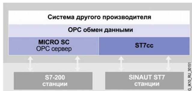
Объединение систем SINAUT MICRO и SINAUT ST7 в компьютерном центре управления на базе программного обеспечения других производителей
