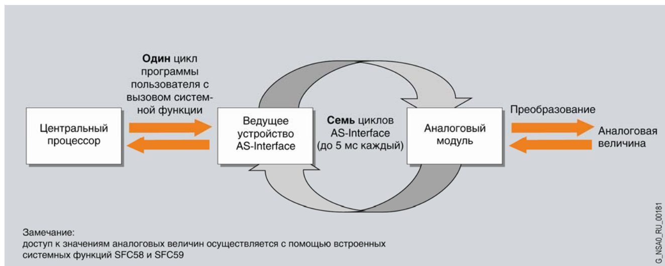
Обмен данными с аналоговыми ведомыми устройствами AS-Interface профилей 7.3/7.4
