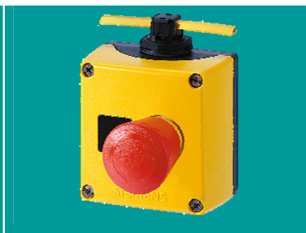
Пластиковый корпус без защитного козырька с подключением к AS-Interface методом прокалывания оболочки и жил профилированного кабеля
