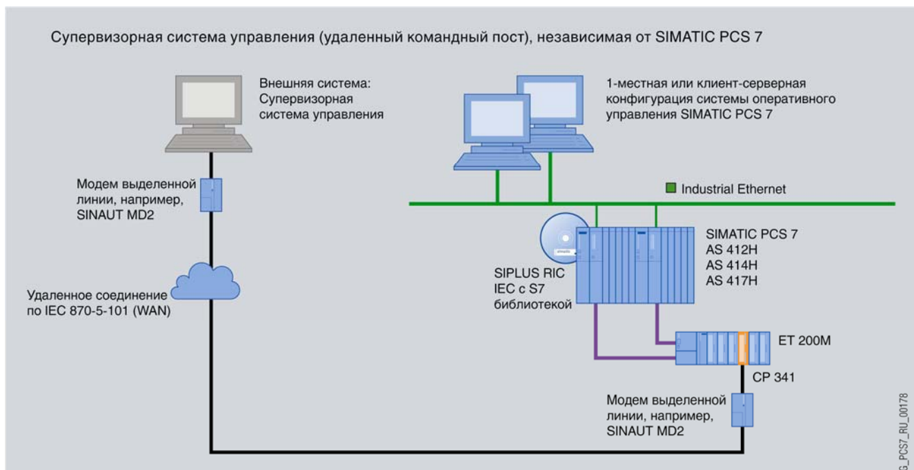
Пример подключения резервированных контроллеров SIPLUS RIC S7 к центру управления стороннего производителя через выделенную линию
